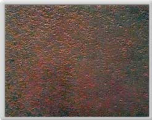
“Consiste en un raspado, cepillado o esmerilado a máquina de una manera muy minuciosa. Se deberá eliminar todo óxido de laminación, herrumbre y pintura que no se encuentre bien adherida. Al término de la limpieza la superficie deberá presentarse rugosa y con un claro brillo metálico. En este tipo de limpieza debe cuidarse de no bruñir la superficie metálica a fin de lograr buena adherencia de las pinturas a la base”.
