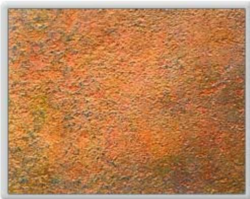
“Deberá eliminarse de la superficie de acero todo el óxido de laminación y herrumbre que se encuentre sin adherencia al igual que la pintura antigua que no se encuentre firmemente adherida. Finalmente se limpiará la superficie con aire limpio y seco o un cepillo limpio. La superficie debe adquirir un suave brillo metálico”.
