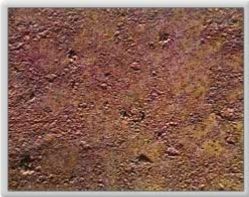
Consiste en un chorreado ligero con partículas abrasivas, donde se elimina la capa suelta de óxido de laminación, herrumbre suelta y partículas extrañas débilmente adheridas. Se permite la presencia de óxido de laminación, pintura antigua y herrumbre que se encuentre firmemente adherida.
