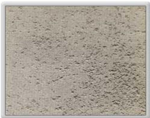
Se define como una limpieza en la cual se elimina toda la suciedad, óxido de laminación, herrumbre, pintura y cualquier materia extraña de la superficie.
